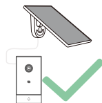
確保電源線自然放置且無拉力
